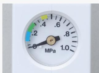
接着材料に合わせた適切なプラスト圧
