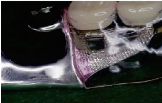
図 1 接着性のないレジンを使用するとフィニッシュラインから染色剤が侵入する(色素侵入試験)
