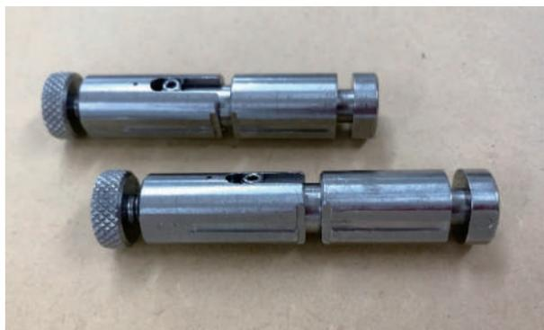
図 1 Microtensile Bond Test で用いられている Ciucchi のジグ
